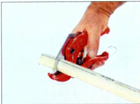
Краят на тръбата се прерязва със специална ножица. Отрезът тръба да бъде гладък и перпендикулярен на тръбата
